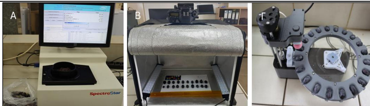
Εικόνα 7. Μετρήσεις Α) ποσοστού υγρασίας, ποσοστού ελαιόλαδου (επί νωπού), ποσοστού ελαιόλαδου (επί ξηρού) με χρήση αναλυτή near-infrared reflectance (NIR) SpectraStar, Β) χρώματος ελαιόκαρπου από φωτογραφία και Γ) αντίσταση στην πίεση με κλίμακα durofel, χρώμα ελαιόκαρπου, διάμετρο ελαιόκαρπου με αυτοματοποιημένο σύστημα Agrosta®WONDERFAST.
